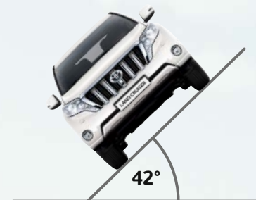
Maximale hellingshoek in zijdelingse richting 42°
